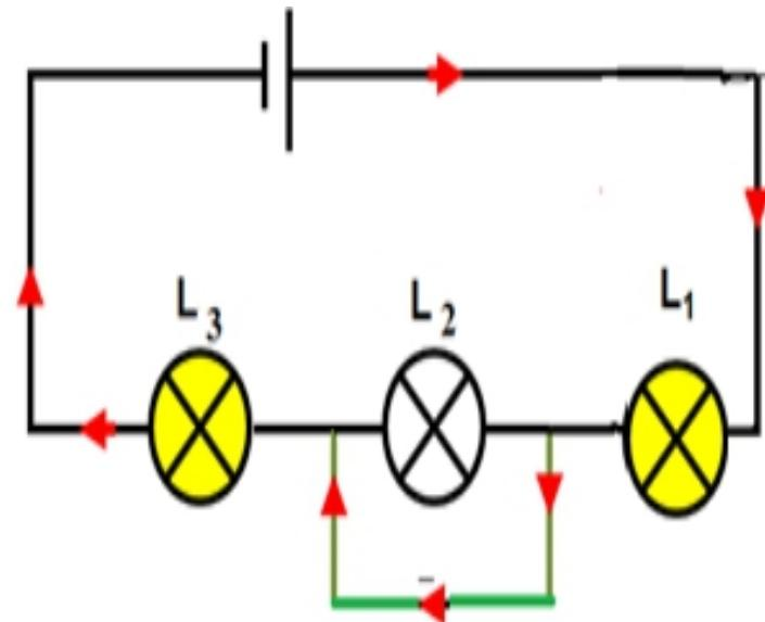
✓ Lorsqu'un fil est ajouté entre les bornes de L<sub>2</sub>, celle –ci s'éteint et l'éclat de L<sub>1</sub> et L<sub>3</sub> devient plus fort.
