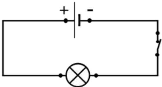
La lampe ne s'allume pas même si le circuit électrique est fermé.
