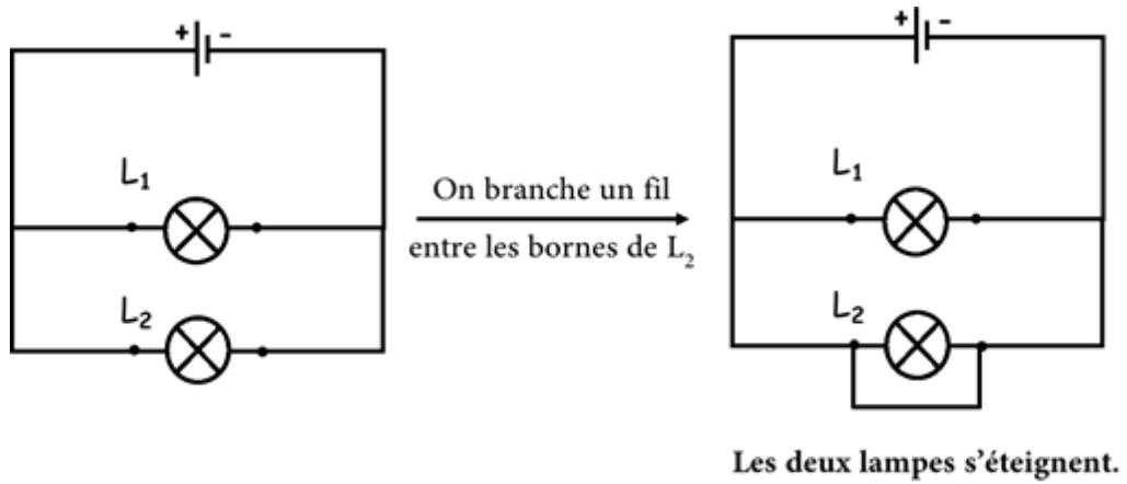
Dans un montage en dérivation, si un récepteur est court-circuité, tous les dipôles montés avec sont aussi court-circuités, et le courant passe par le court-circuit et devient alors très intense.
