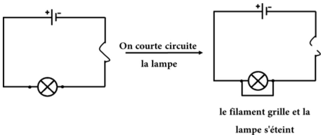
Pour protéger un élément du circuit contre les courts-circuits, on lui branche en série un filament métallique qui fond immédiatement après un court-circuit, provoquant l'ouverture du circuit. On l'appelle fusible.
