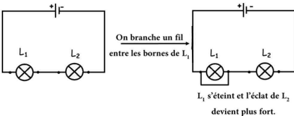
Dans un montage en série, si un récepteur est court-circuité, il ne fonctionne plus et le courant passe par le court-circuit et devient alors très intense.
