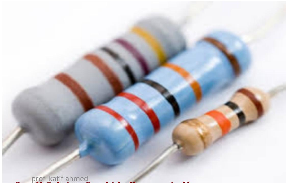
Pour connaître la valeur de la résistance d'un conducteur ohmique, les fabricants placent des anneaux colorés. Tout d'abord il faut placer la résistance devant soi comme l'indique le schéma ci-dessous avec les 3 anneaux colorés à gauche.
