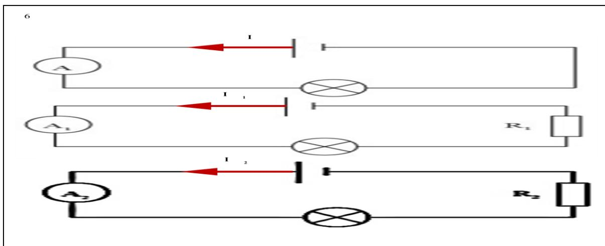
Résultats:  $I = 0,16 \text{ A}$  et  $I_1 = 0,08 \text{ A}$  et  $I_2 = 0,02 \text{ A}$
