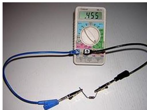
La résistance de ce conducteur ohmique est d'environ  $455 \Omega$  ( $0,455 \text{ k}\Omega$ ).
