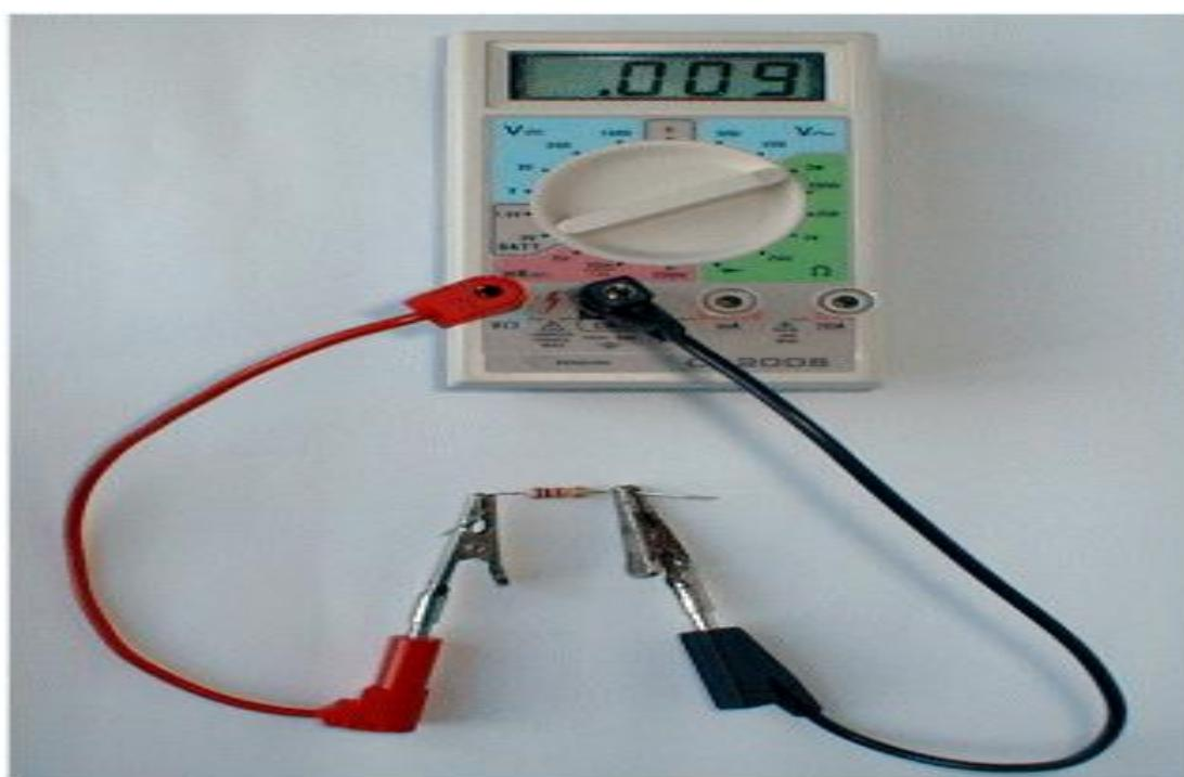
La résistance à mesurer est simplement branchée entre la borne COM et la borne repérée par la lettre  $\Omega$ .
