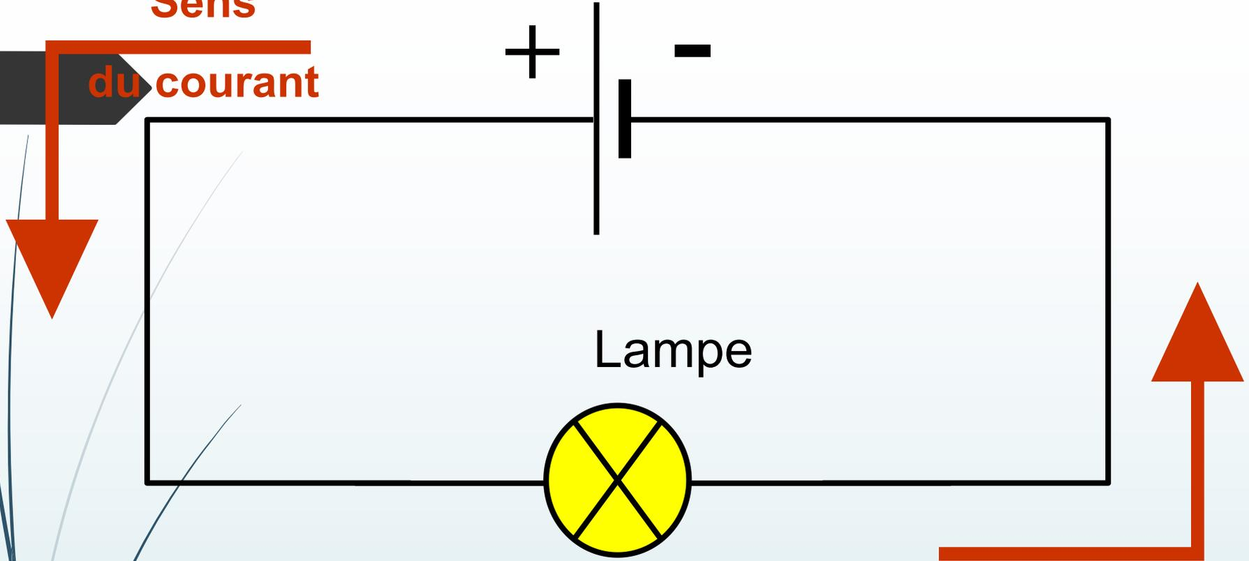
Par convention, a l'extérieur du générateur, le courant électrique *de la borne + vers la borne -*.
