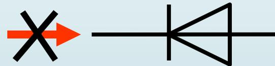
Aucun courant dans le circuit
