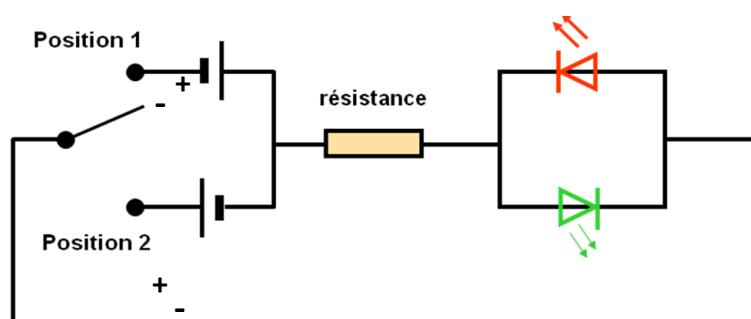
**dispositif de commande à diodes**
