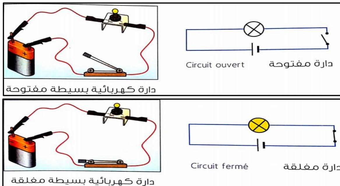
Un circuit électrique est représenté simplement par un schéma électrique :
