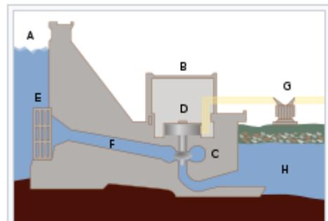
Schéma en coupe d'un barrage hydroélectrique.
