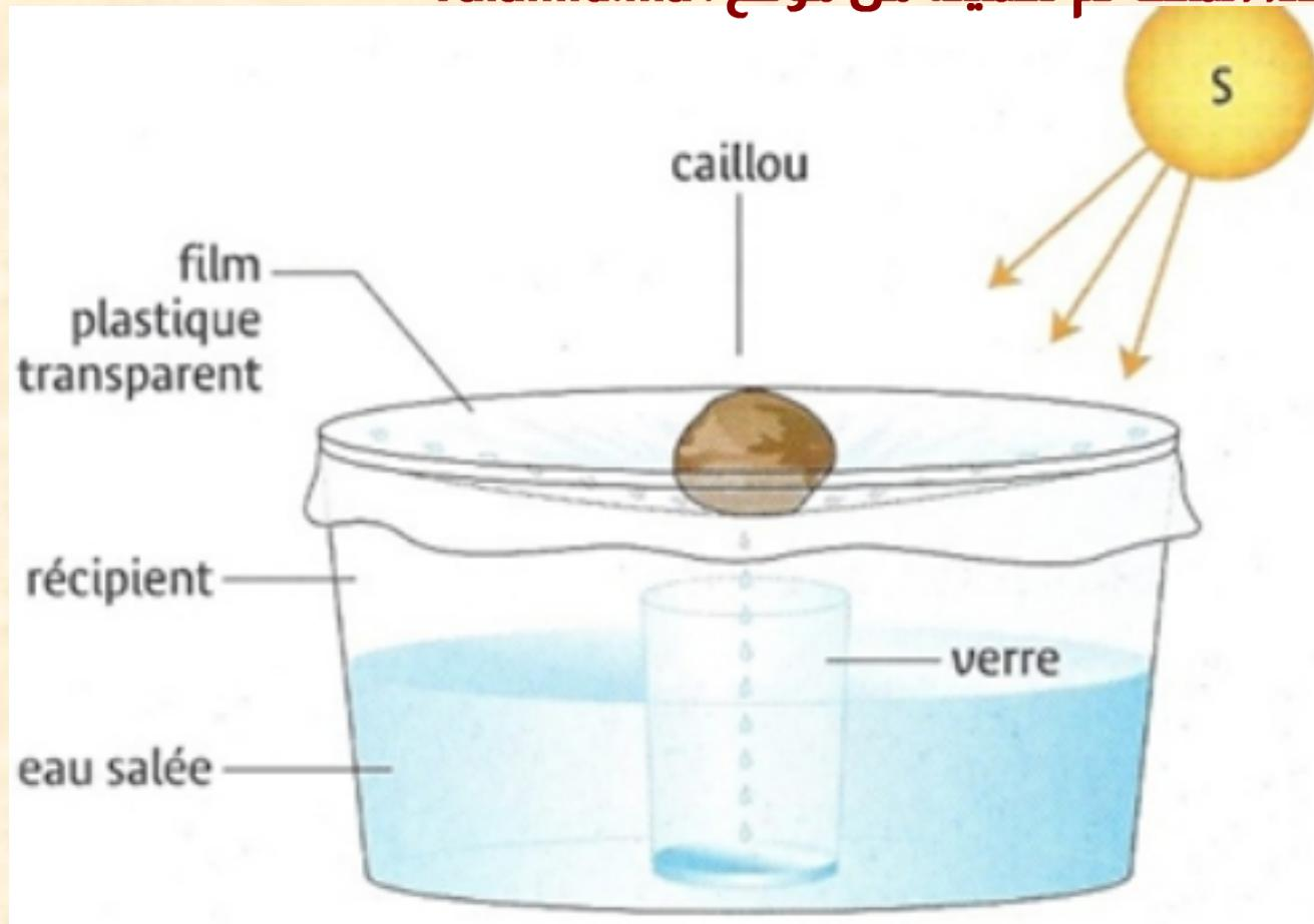
*Décrire avec le schéma du dispositif, le principe d'un "distillateur solaire" ?*
