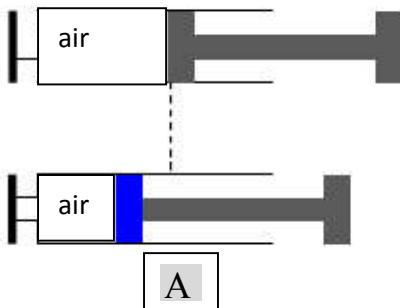
On ferme l'orifice de la seringue et on tire le piston.
