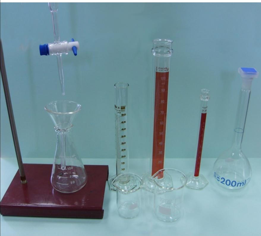
Pour mesurer le volume d'un liquide il suffit d'utiliser de récipient comportant des graduations comme : l'éprouvette graduée.
