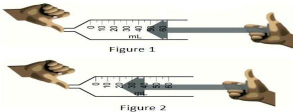
**B- Observation** : En appuyant sur le piston d'une seringue qui renferme de l'air et dont l'extrémité est bouchée, on diminue le volume du gaz enfermé. Inversement on augmente le volume du gaz.
