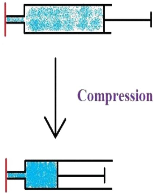
En bouchant la sortie, on peut comprimer le gaz jusqu'à un certain point : le gaz est compressible
