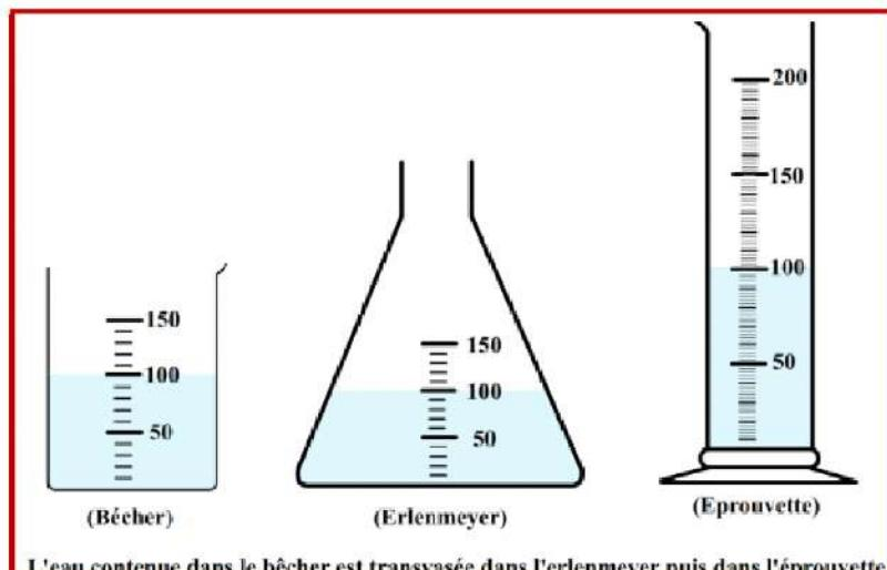
L'eau contenue dans le bêcher est transvasée dans l'Erlenmeyer puis dans l'éprouvette
