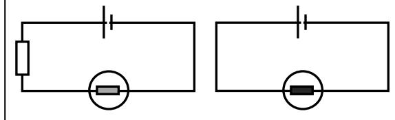
نلاحظ أن إضاءة المصباح أصبحت ضعيفة بعد إضافة الموصل الأومي على التوالى في الدارة الكهربائية كما نلاحظ انخفاض شدة التيار الكهربائي ونستنتج أن الموصلات الأومية تقاوم مرور التيار الكهربائي.
