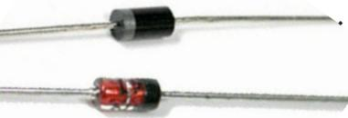
تجربة : نركب دارة كهربائية بسيطة تتكون من عمود و مصباح  $L_1$  و قاطع للتيار  $K$  و صمام ثانوي  $D_1$ . الصمام الثنائي القطب الإلكتروني ينحصر دوره في السماح بمرور التيار الكهربائي في منحى واحد فقط ويرمز له بالرمز :
