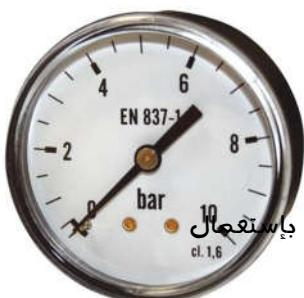
جهاز المانومتر Manomètre، الوحدة العالمية لقياسه هي **الباسكال** يرمز لها ب **Pa**.
