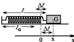
Ressort horizontal initialement non allongé et fixé directement au mobile ou au moyen d'un fil inextensible et de masse négligeable
