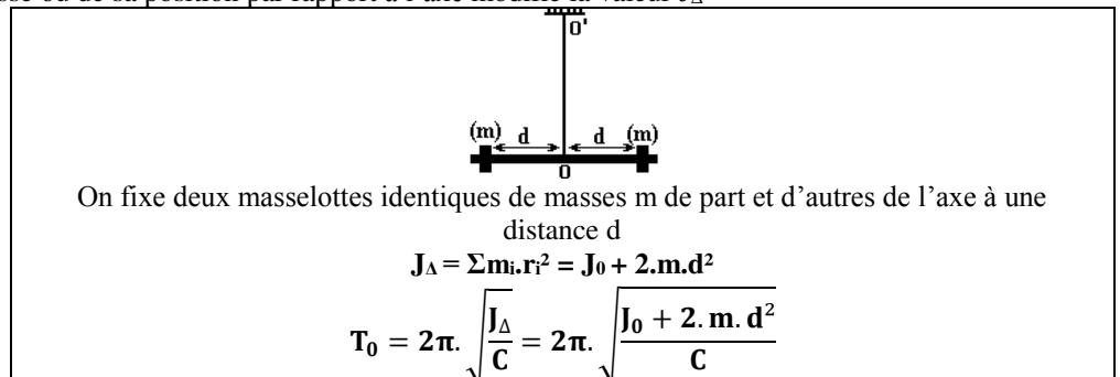
On fixe deux masselottes identiques de masses  $m$  de part et d'autre de l'axe à une distance  $d$
