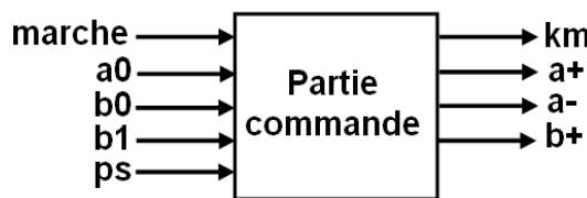
Pour les actionneurs commandés monostable (cas du moteur et du vérin B), tous les mouvements existent mais seules les commandes effectives sont repérées (pas d'ordre b- dans cet exemple, c'est le ressort du distributeur qui permet d'obtenir le mouvement B-).
