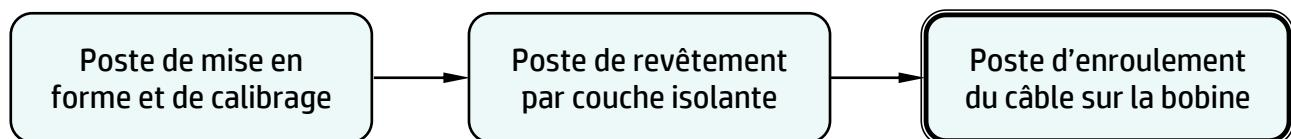
On s'intéressera au **poste d'enroulement du câble sur la bobine** (voir la représentation schématique des trois mécanismes page 3/18) qui permet d'enrouler le câble électrique sur la bobine. Ce poste utilise l'**énergie électrique** et **pneumatique**, il est principalement constitué des trois mécanismes suivants :
