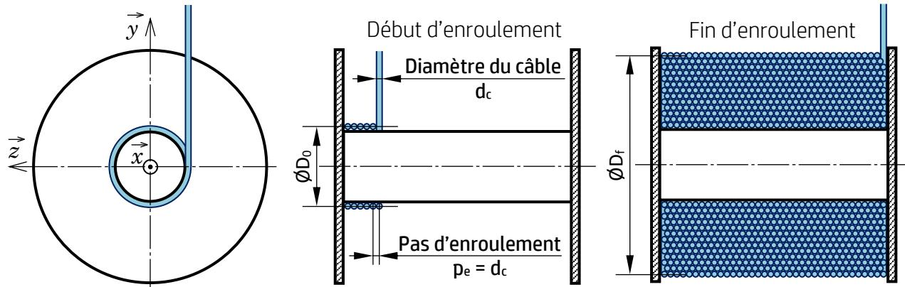
**Tâche 22 :** Le but de la tâche est d'étudier le comportement cinématique du mécanisme de répartition du câble sur la bobine permettant l'enroulement régulier du câble électrique le long de la bobine. En se référant à la présentation du support (pages 2/18 et 3/18) et au schéma ci-dessus de la bobine en phase début et phase fin d'enroulement du câble, répondre aux questions du (DREP page 10/18).
