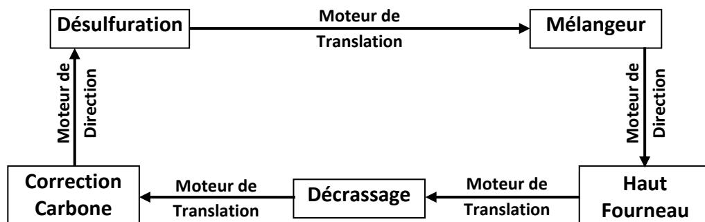
Grafct relatif au déplacement de la poche du (poste de correction de carbone) au (poste de désulfuration) :
