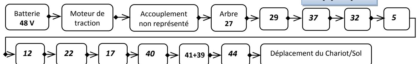
d- Le schéma cinématique minimal du mécanisme de traction:
