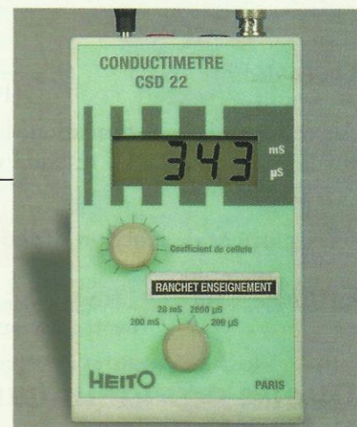
Doc. 9 Résultat de la mesure : \sigma = 343 \, \mu\text{S} \cdot \text{cm}^{-1}
