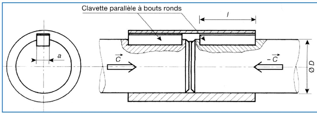
c - Plateaux clavettes et Boulons
