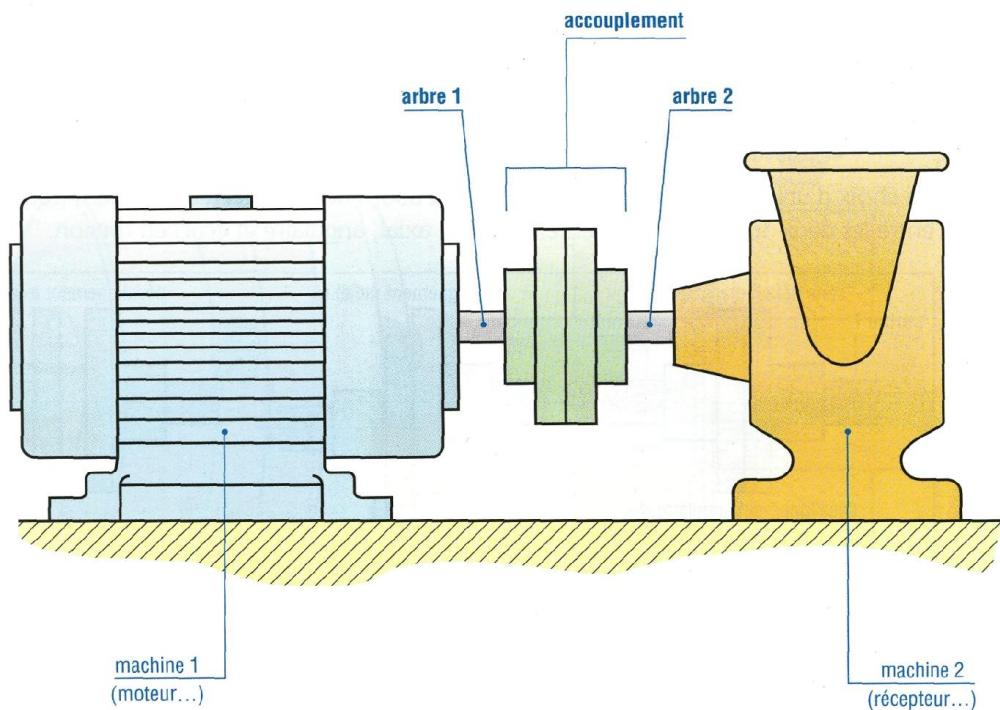
La Transmission de l'Energie mécanique du moteur électrique à la Pompe Centrifuge est assurée par un **Mécanisme de Transmission** Appelé **Accouplement**
