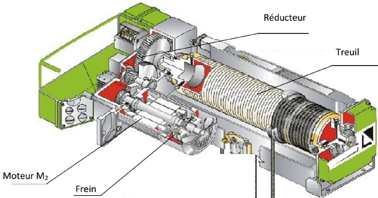
Le moteur du treuil du pont roulant est muni d'un frein électromagnétique à manque de courant, monté à l'arrière du moteur. Ce frein (voir dessin d'ensemble partiel) se compose de :
