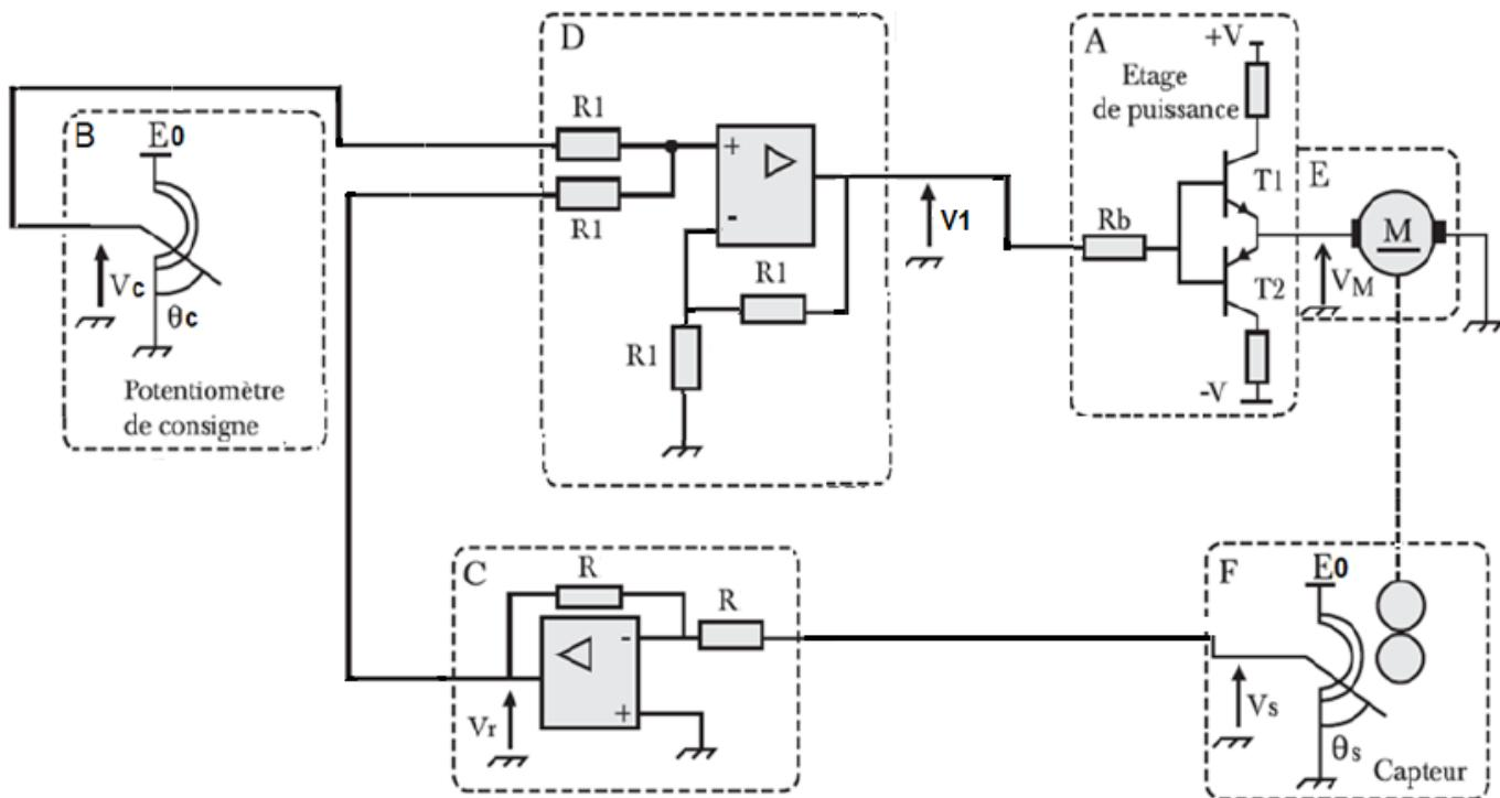
L'angle maximal balayé par les deux curseurs associés au capteur et au potentiomètre de consigne correspond à  $180^\circ$  et délivrant ainsi la tension de référence  $E_0 = 12V$ .
