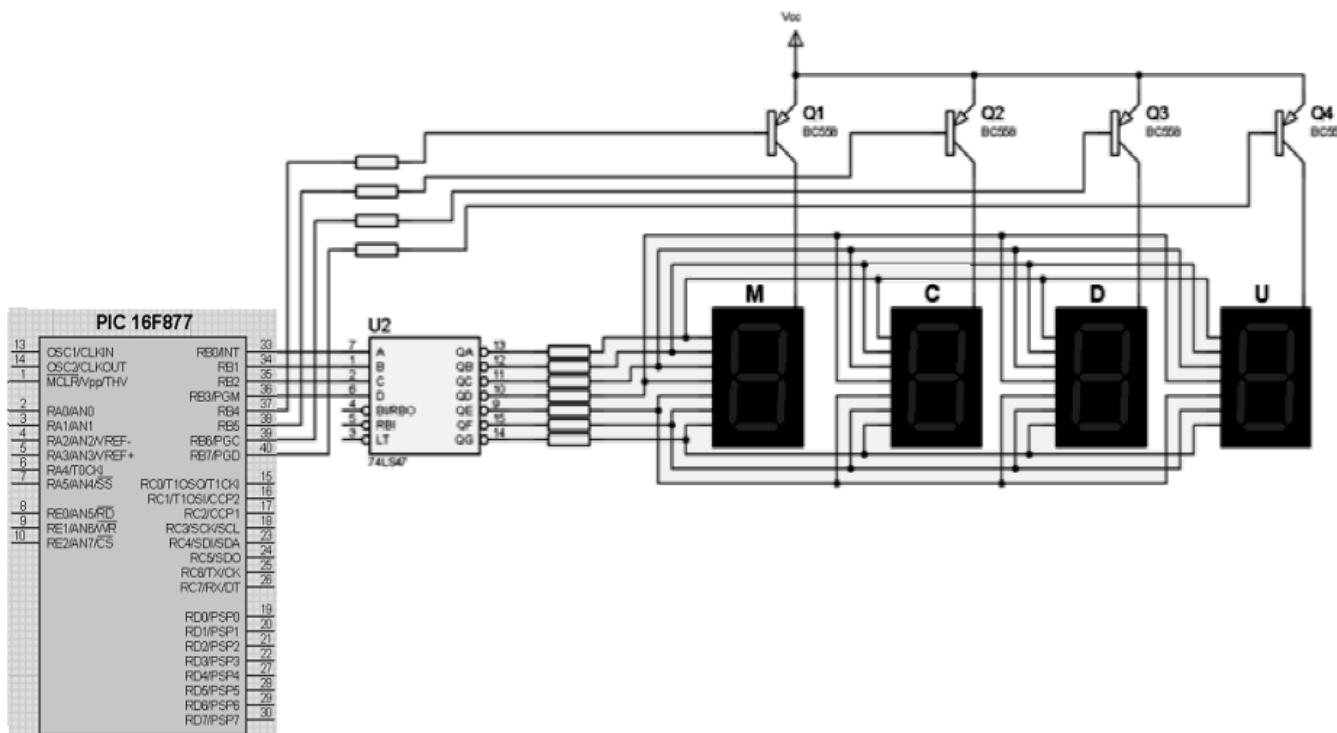
Le montage réalise un comptage de 0 à 9999. Le circuit U2 étant un décodeur BCD/7ségments ; les transistors Q de type PNP commandent la sélection des afficheurs
