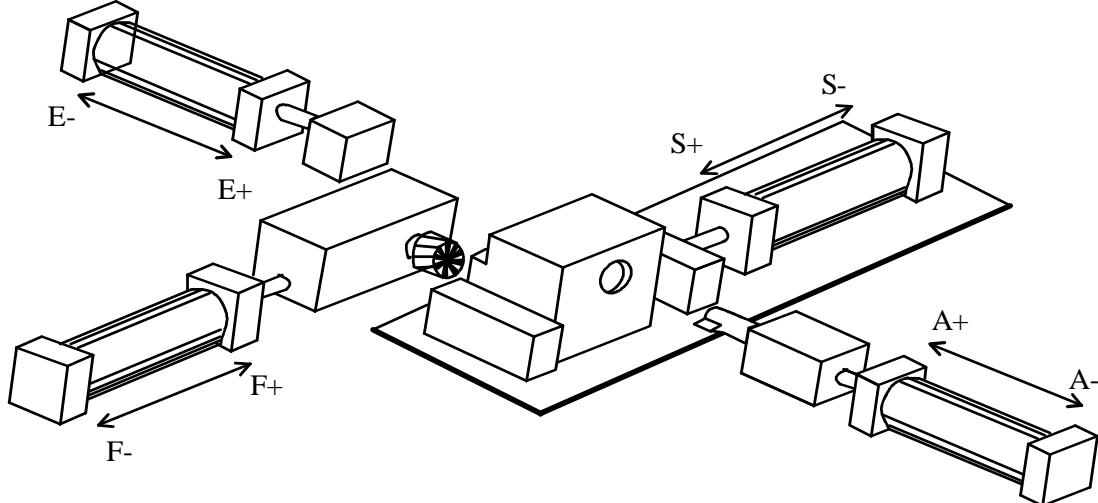
Cette machine effectue deux usinages: le fraisage (grâce au vérin F) et le lamage (grâce au vérin A). Les vérins S et E assurent respectivement le serrage et l'éjection.
