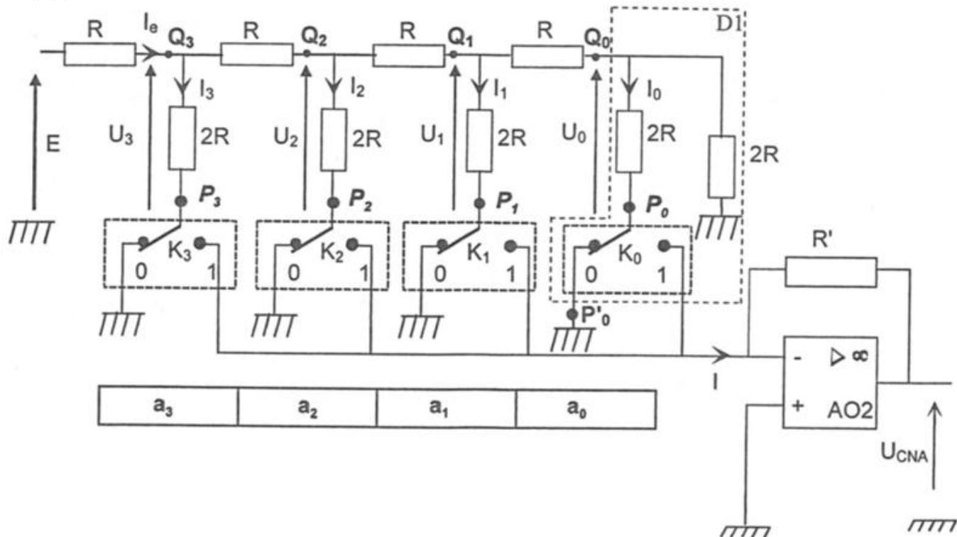
Pour  $i = 0, 1, 2$  ou  $3$ , la position de l'interrupteur  $K_i$  dépend de la valeur du bit  $a_i$ : Si  $a_i = 0$  alors  $K_i$  est en position 0 et si  $a_i = 1$  alors  $K_i$  est en position 1 (voir figure ).
