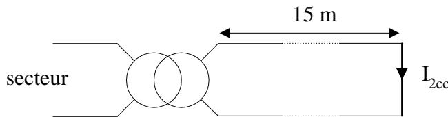
Le câble de ligne en cuivre a une section de 1,5 mm<sup>2</sup>.
