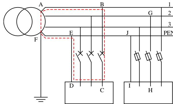
On donne  $L_{BC} = L_{ED} = 100 \text{ m}$  (câble en cuivre  $\rho = 2,25 \cdot 10^{-8} \Omega \text{m}$ )
