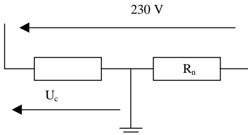
2. Déterminer la tension de contact de la machine M2 par rapport au sol.
