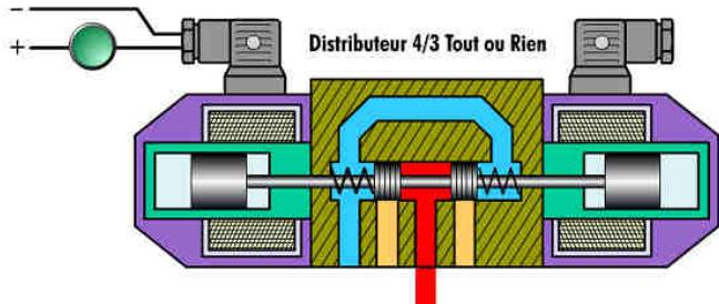
Lorsque la bobine du distributeur TOR **est alimentée**, le **tiroir** se déplace complètement à droite, permettant **le passage total du débit**
