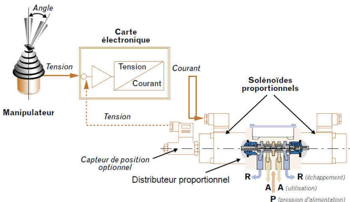
Le manipulateur délivre une tension électrique proportionnelle à son déplacement angulaire. Une carte électronique de traitement, propre à chaque distributeur, transforme ensuite cette tension en un courant électrique. Le solénoïde (bobine) proportionnel opère la transformation de ce courant en un déplacement (ou en une force), directement appliquée au tiroir du distributeur.
