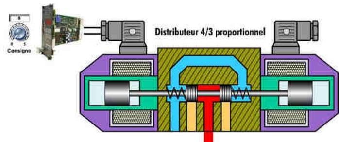
La consigne est **non nulle mais de faible valeur**. La force de la bobine proportionnelle a déplacé le tiroir en opposition à l'action mécanique du ressort jusqu'à une position d'équilibre. **Le débit est faible**. La consigne est **maximale**. La force plus importante de la bobine a déplacé complètement le tiroir à droite. **Le débit passant par le distributeur est maximal**.
