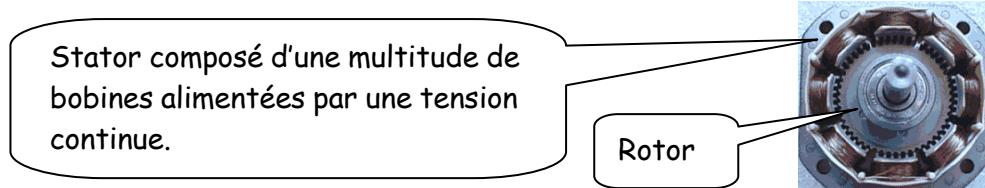
On rencontre les moteurs pas à pas **unipolaire** et **bipolaire** qui se différencient par la structure de leur stator et leur commande.
