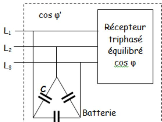
Détermination de la capacité :
