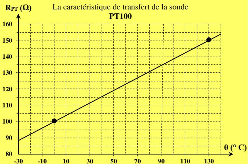
**Q34-** Indiquer les grandeurs d'entrée et de sortie de ce capteur en précisant l'unité de chaque grandeur. **1 pt**
