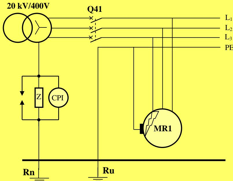
**Q28-** Compléter le schéma équivalent du circuit de défaut.
