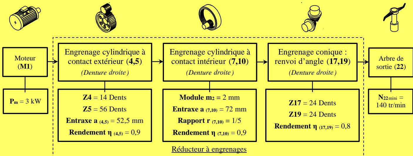
**Q6- Calculer le rapport de transmission  $r_{(4,5)}$  de l'engrenage (4,5).**
