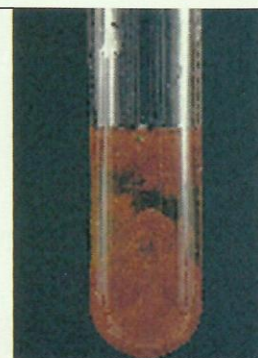
Doc. 4 La précipitation de l'hydroxyde de fer (III) permet la mise en évidence des ions fer (III).
