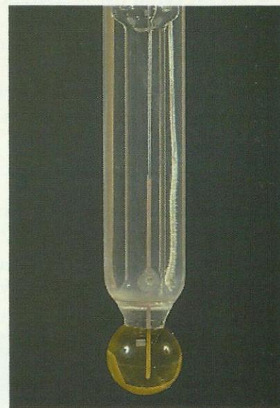
Doc. 6 Sonde de mesure du pH.
