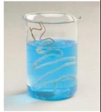
Le **corps solide brillant** qui apparaît sur la **fil de cuivre émergé** est le **métal argenté**  $\text{Ag}_{(s)}$ . Alors, l'**ion  $\text{Ag}_{(aq)}^+$**  se **transforme** au **métal  $\text{Ag}_{(s)}$**  selon la **demi-équation** :  $\text{Ag}_{(aq)}^+ + e^- \rightleftharpoons \text{Ag}_{(s)}$  .
