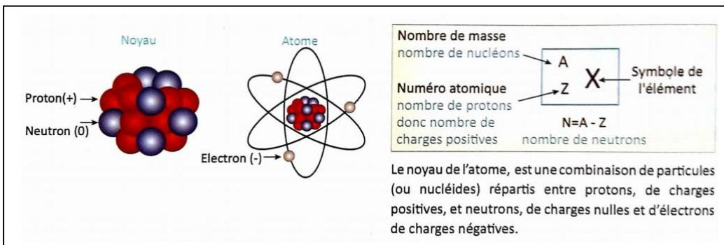
L'organisation du noyau atomique, de la matière dépend des forces de cohésion entre ses éléments (Neutrons, protons et électrons). C'est l'instabilité de cette cohésion qui rend la matière radioactive. La différence entre les atomes des différents éléments est défini par le nombre des protons (ou des électrons) que contient chaque atome. Le nombre de neutrons peut varier au sein des atomes du même élément, formant ce qu'on appelle les isotopes.
