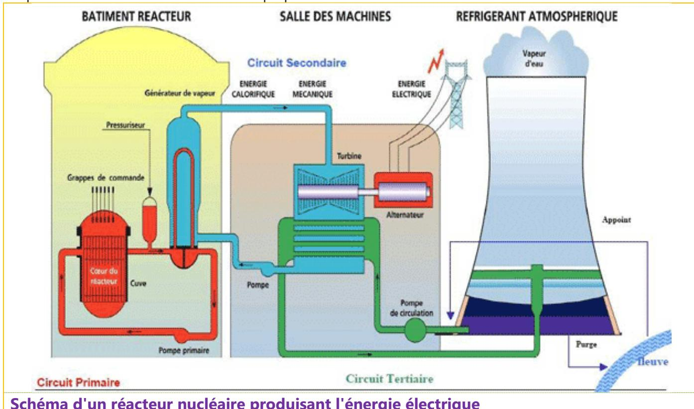
Schéma d'un réacteur nucléaire produisant l'énergie électrique
