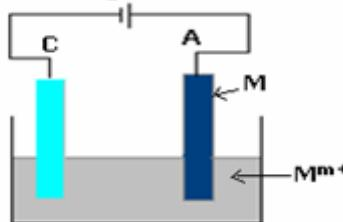
Le bilan de la réaction est nul et cette électrolyse commence à partir de 0V.
