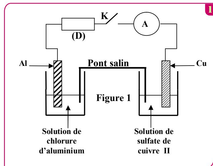
On branche entre les pôles de la pile un conducteur Ohmique (D), un ampèremètre et un interrupteur K (figure1).
