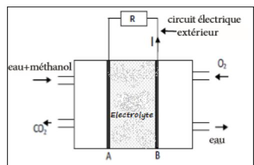
Pendant le fonctionnement de la pile , il se produit près de l'une des électrodes une transformation modélisée par l'équation chimique suivante :  $CH_3OH + H_2O \longrightarrow CO_2 + a.H^+ + b.e^-$
