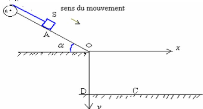
1) On libère le corps S du point A sans vitesse initiale et il glisse sans frottement sur le plan incliné provoquant la rotation du cylindre.
