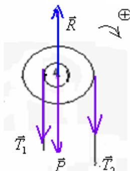
Condition d'équilibre:  $\sum M_F = 0 \Rightarrow M\vec{P}_A + M\vec{R}_A + M\vec{T}_1 + M\vec{T}_2 = 0$  En choisissant le sens positif de rotation :
