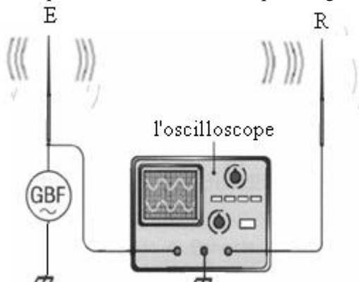
L'antenne émettrice E émet une onde électromagnétique de même fréquence que le signal électrique du circuit. Cette onde se propage dans tout l'espace et provoque dans l'antenne réceptrice R un signal de même fréquence.
