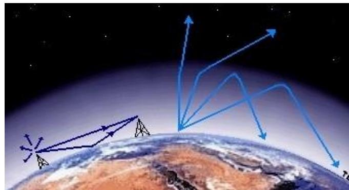
Une autre façon de parcourir de grandes distances à la surface de la Terre est obtenue au moyen de satellites qui sont en orbite au-delà de l'ionosphère : l'onde traverse l'ionosphère en subissant une réfraction et est captée par un satellite qui la renvoie sur Terre. Pour cela, il faut utiliser des ondes de haute fréquence, capables de franchir l'ionosphère. C'est le cas des ondes utilisées en radio FM, par la télévision par satellite, pour les téléphones cellulaires.
