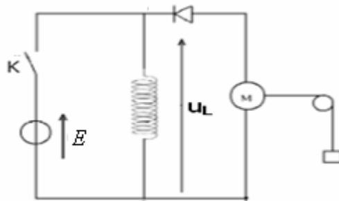
On ferme l'interrupteur k à l'instant  $t=0$  ,un courant électrique traverse la bobine car la diode est bloquante , elle empêche le courant de passer dans le moteur puis on ouvre l'interrupteur , on constate que le moteur fonctionne et le corps suspendu au fil monte d'une hauteur h.
