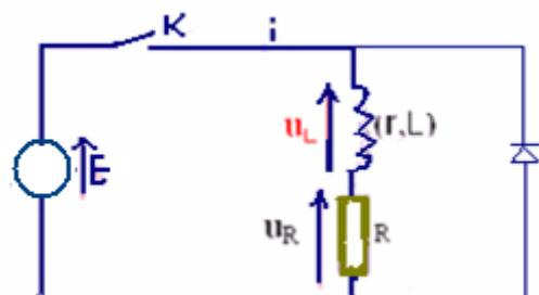
En appliquant la loi d'additivité des tensions on a  $u_L + u_R = 0 \Rightarrow (L \frac{di}{dt} + ri) + R.i = 0 \Rightarrow L \frac{di}{dt} + (r + R)i = 0$
