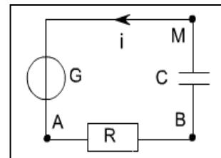
On relie la masse d'un oscilloscope à mémoire au point M, la voie X au point B.
