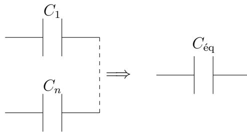
Puisque le montage est en parallèle alors :  $u = u_1 = \dots = u_n$  et  $i = i_1 + \dots + i_n \iff q = q_1 + \dots + q_n$ .
